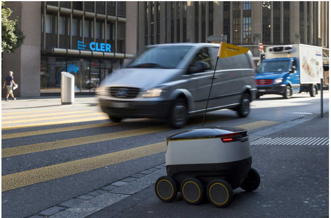
Abbildung 77: Paketroboter im Testeinsatz (Post CH AG, 2017)
